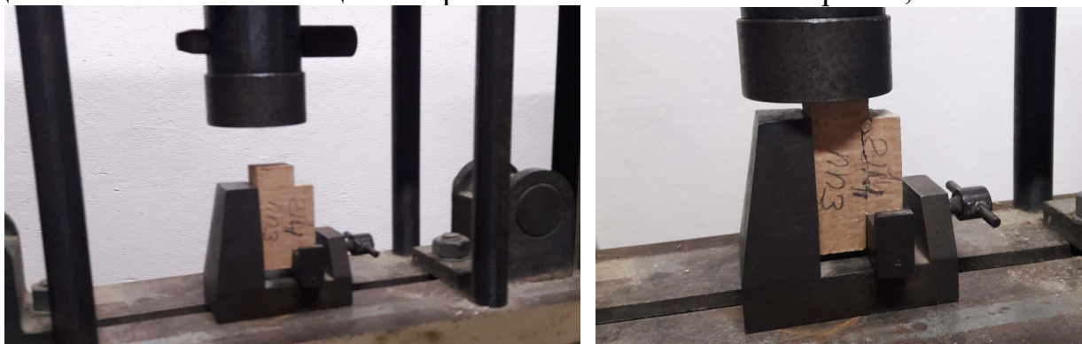
Рис. 6. Випробування на міцність при сколюванні
