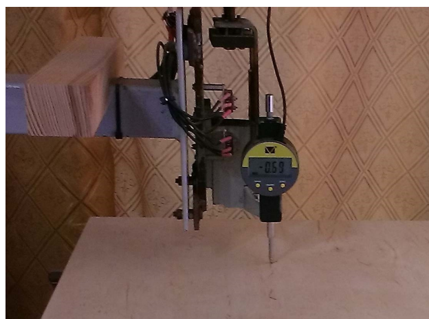
Рис. 3. Установка з ЧПУ для визначення формостійкості МЩ із бука звичайного ( Fagus sylvatica L.) комбінованого укладання
