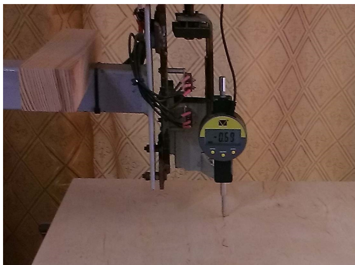
Рис. 10. Установка з ЧПУ для визначення формостійкості МЩ із бука звичайного ( Fagus sylvatica L.) комбінованого укладання
