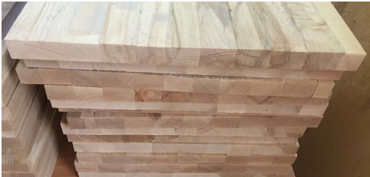
Рис. 9. Стопа некаліброваних меблевих щитів із деревини твердолистяних порід, зокрема бука звичайного ( Fagus sylvatica L.) на стелажах технологічної витримки
