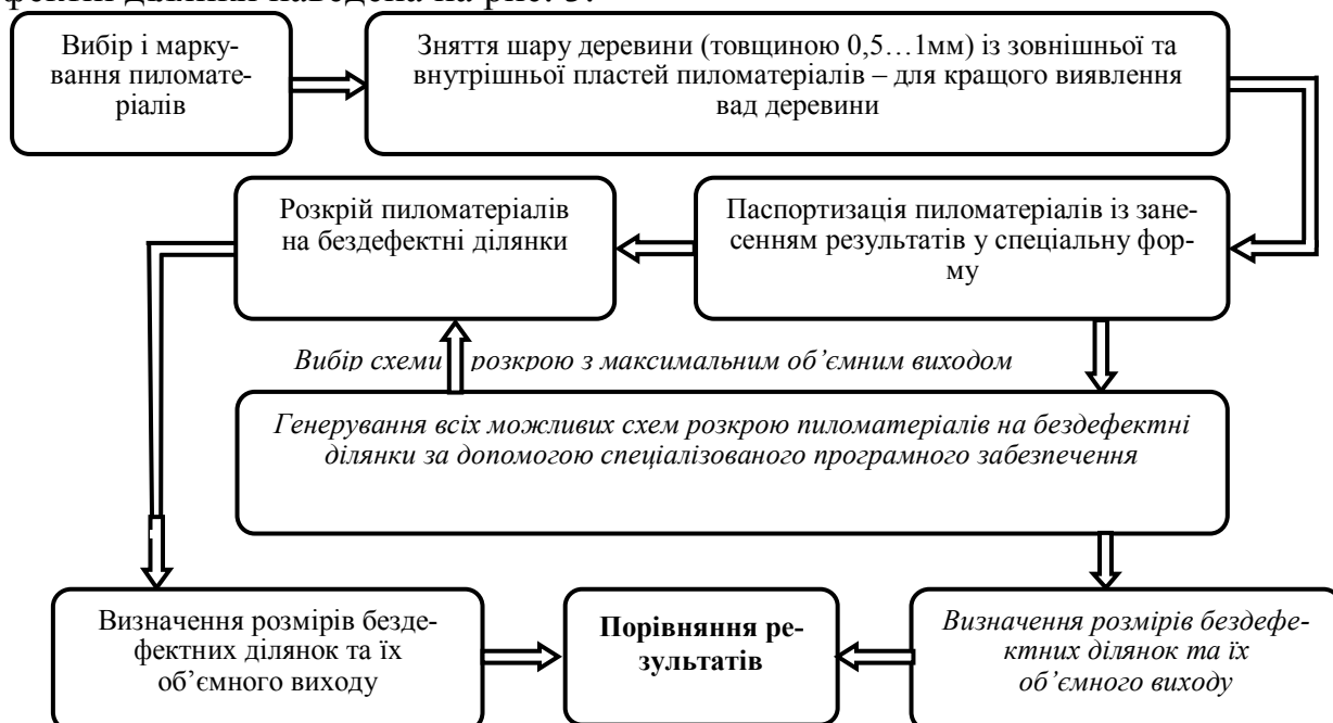
Рис. 3. Схема послідовності виконання досліджень з розкрою пиломатеріалів на бездефектні ділянки
