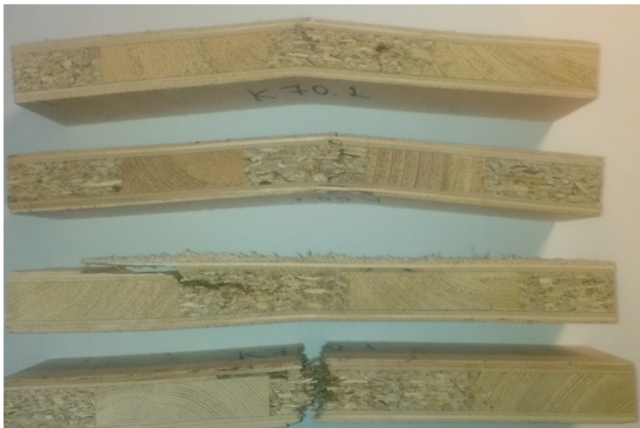
Рис. 17. Зразки комбінованої СП(Брусok-ДСП)ВЖД під навантаженням та в момент руйнування
