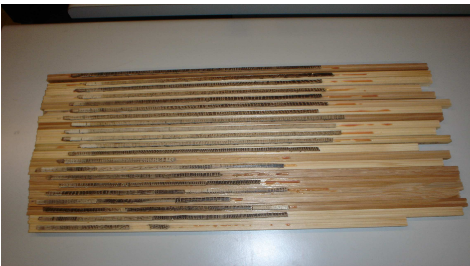
Рис. 1. Підготовка кернів дуба звичайного для замірів річних приростів
