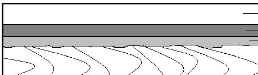
Рис. 1. Схема комбінованого полімерного покриття на деревній підкладці: 1 – деревна підкладка; 2 – грунтовка; 3 – шпаклівка; 4 – лак
