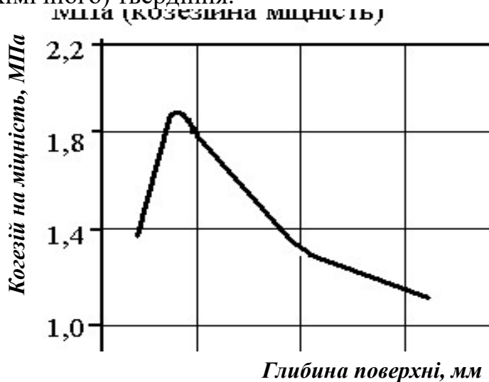
Рис. 3. Залежність аутокогезійної міцності комбі- нованого пок- риття від глиби- ни засвердлюван- ня
