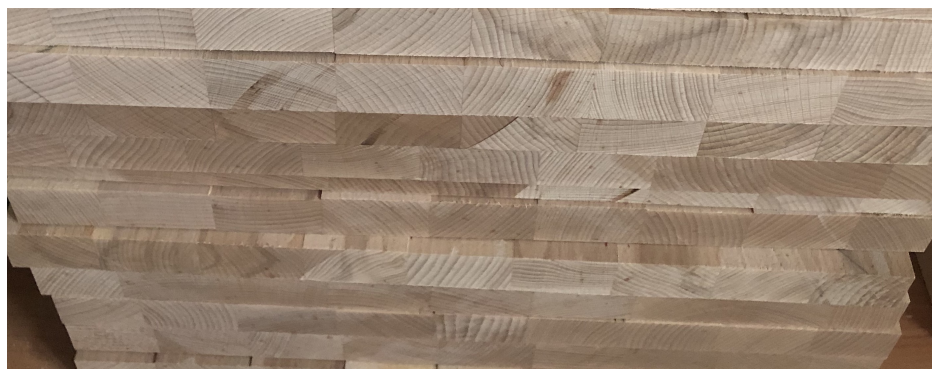
Рис. 1. Конструкція меблевого щита із склеєних рейок дере- вини бука товщиною 20 мм
