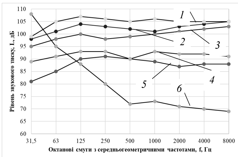
Рис. 3. Спектри шуму стрічковопилкового верстата на неробочому ході: 1 – без стрічки; 2 – зі стрічкою без натяжних опор; 3 – зі швом звареним дуговим зварюванням напівавтоматом під кутом 90^\circ ; 4 – лазерним зварюванням під кутом 90^\circ ; 5 – лазерним зварюванням під кутом 60^\circ ; 6 – гранично допустимий
