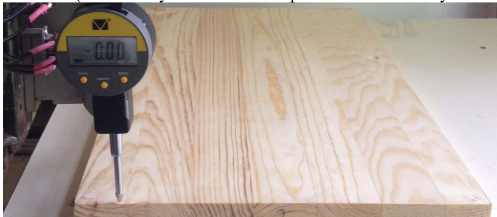
Рис. 1. Експериментальна установки ЧПУ для визначення формостійкості
