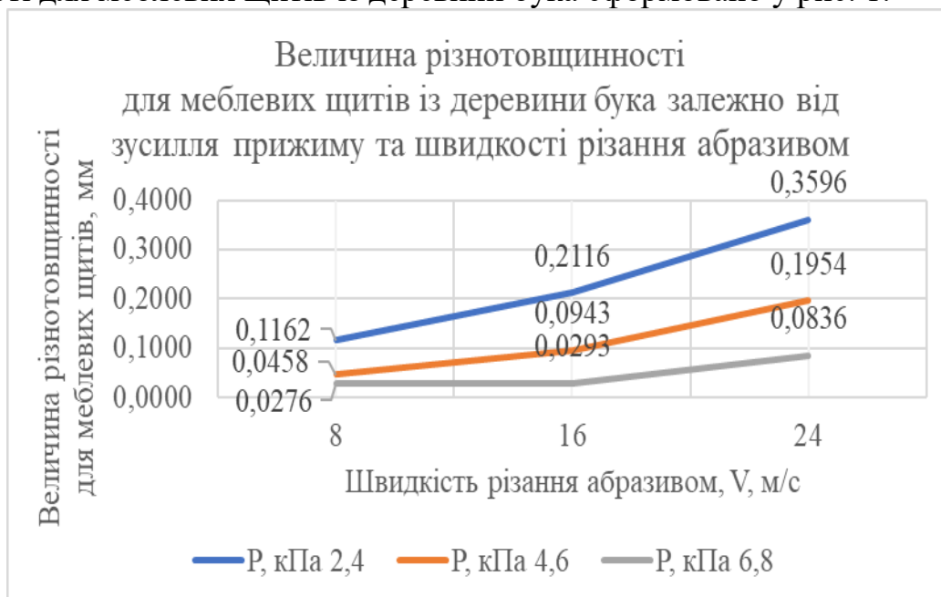
Рис. 1. Величина різнотовщинності для меблевих щитів із деревини бука залежно від зусилля прижиму та швидкості різання абразивом
