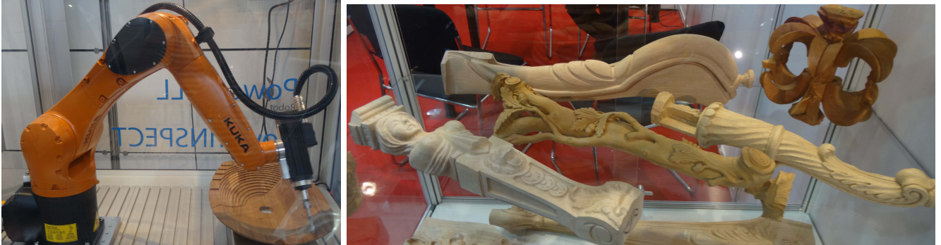
Рис. 4. Оброблювальний робот KR німецької компанії KUKA
