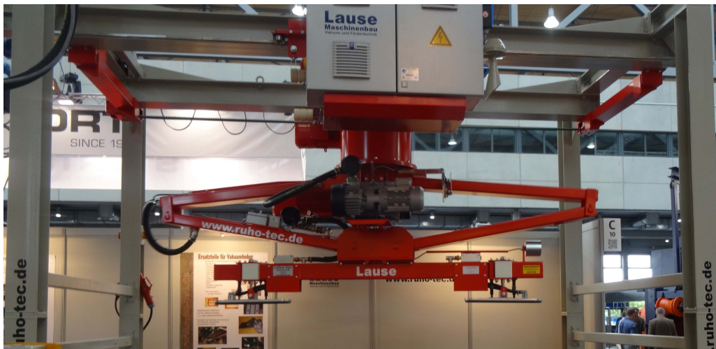
Рис. 1. Транспортно-вакуумний робот-штабелер Vakuim Roboter Lause
