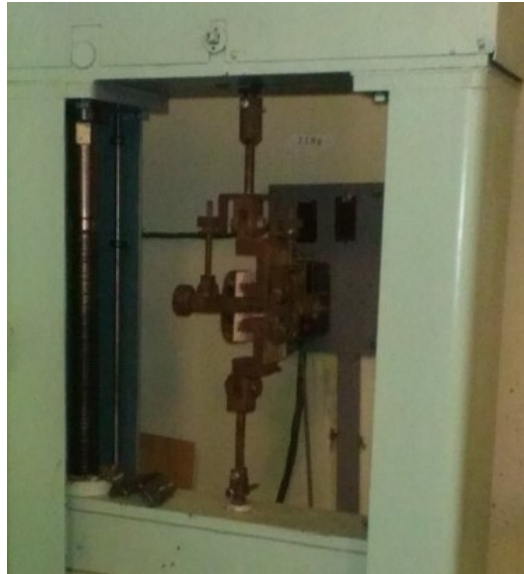
Рис. 1. Момент випробування взірців столярної плити із ВЖД
