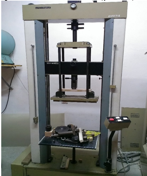
Рис. 1. Момент випробування взірців столярної плити із ВЖД
