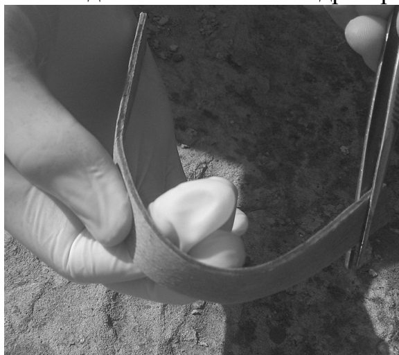
Рис. 2. Заготовка, після витримки у розчині аміаку, максимально пластифікується і згинається легким зусиллям рук
