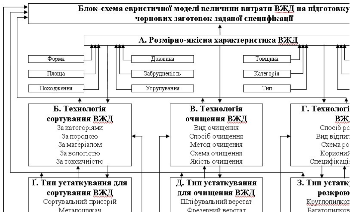
Рис. 3. Блок-схема евристичної моделі величини витрати ВЖД на виробництво чорнових заготовок заданої специфікації
