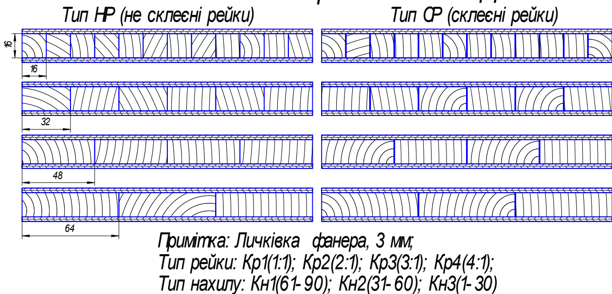
Рис. 1. Конструкції столярних плит із ВЖД комбінованого укладання
