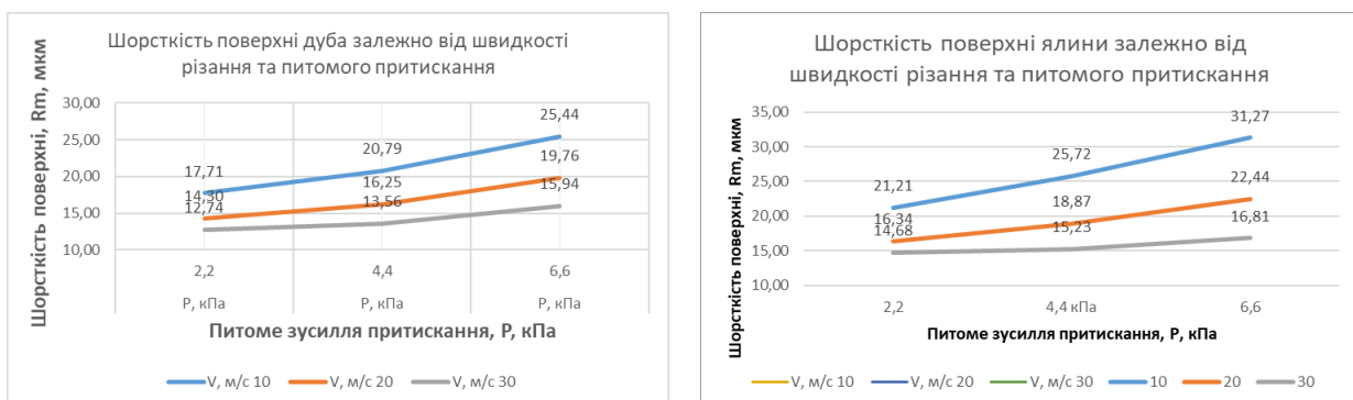
Рис. 3. Залежність шорсткості поверхні від зусилля притискання
