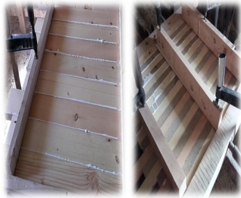
Рис. 12. Процес нанесення клею П-ВА моделі «J-o-w-a-t 1.0.3.0.5» та сти- скання у пристосуваннях
