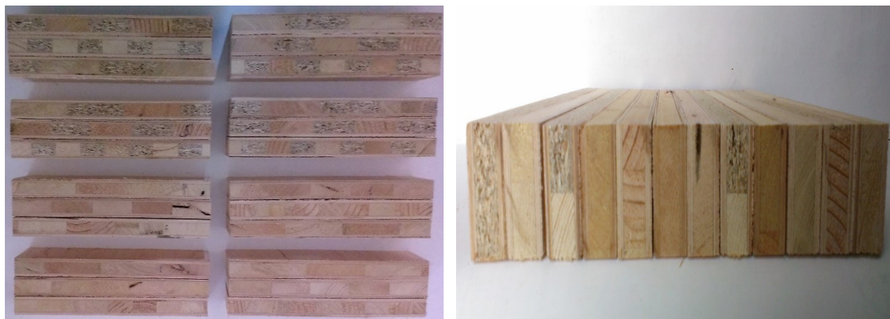
Рис. 6. Загальний вигляд експериментального зразка СП із ВЖД так і ВЖД (ДСП) різних конструкцій для випробовування показника міцності під час статичного згину впоперек рейок
