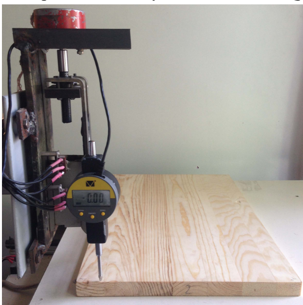
Рис. 2. Експериментальна установка з ЧПУ для визначення формостійкості
